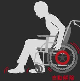
着座した状態で、駆動輪が進行方向に回ると自動的にロックを解除します。
