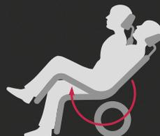
バックサポートと座面の角度を保ったまま後方に傾けられます。
